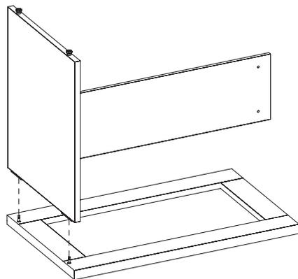
2.4 Apoie o tampo sobre uma superfície limpa e encaixe a estrutura. Em seguida trave as cuícas.
