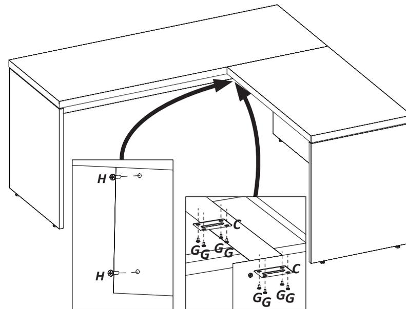
2.6 Fixe os parafusos do painel frontal. Em seguida, posicione as chapas de conexão e fixe com os parafusos indicados. Dê acabamento colocando os tapa furos.
